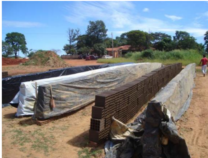
Figura 2 – Secagem de blocos cerâmicos de modo natural (ar livre)
