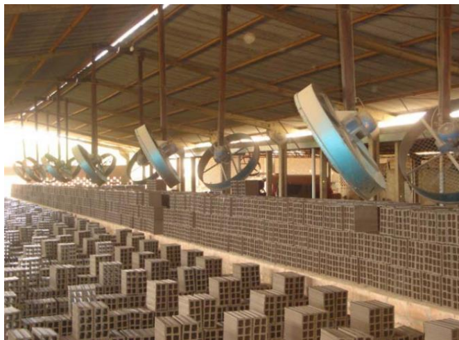
Figura 3 – Secagem de blocos cerâmicos em estufa pelo processo artificial com uso de ventiladores
