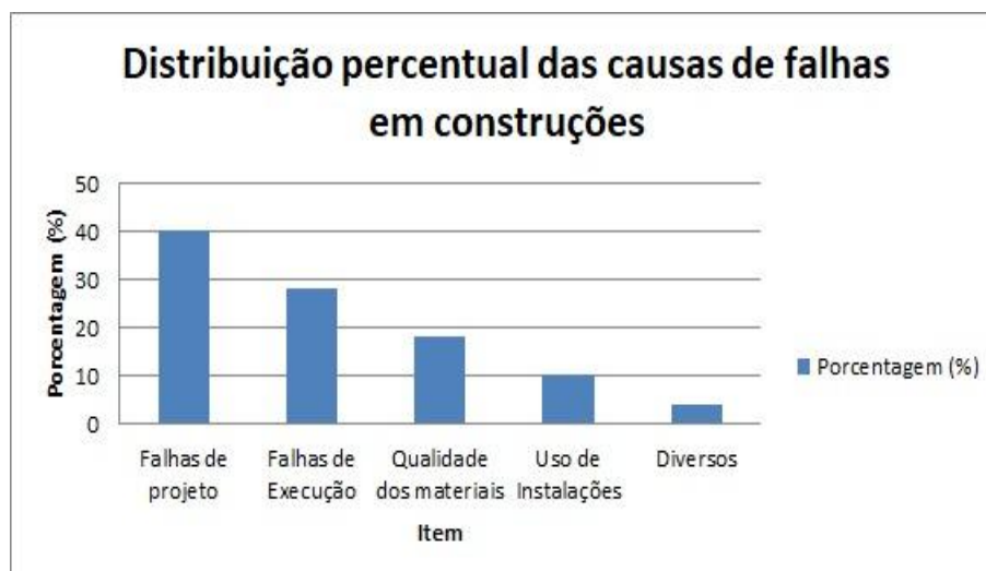
Figura 8 - Distribuição percentual das principais causas de anomalias em edificações.
