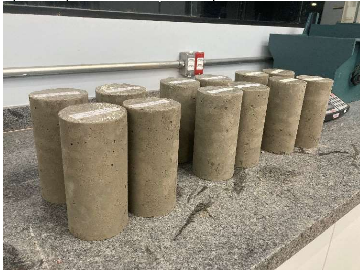
Figura 29 – Corpos de prova desmoldados para o ensaio de compressão axial.
