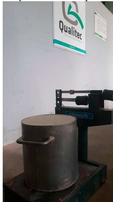
Figura 14 - Ensaio para determinação de massa unitária.
