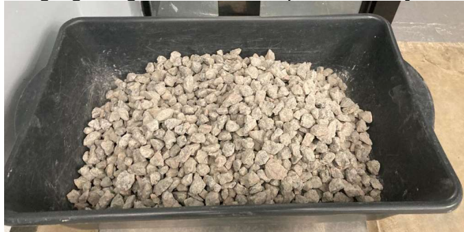
Figura 12 - Agregado graúdo utilizado para confecção do concreto.
