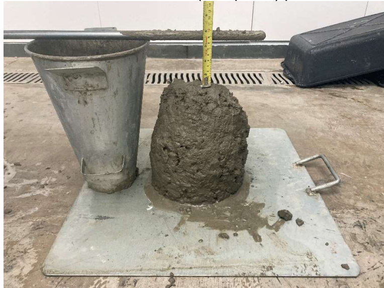
Figura 27 – Ensaio de abatimento ( slump test ) para o fck de 25 MPa.
