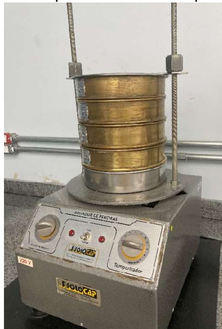
Figura 26 – Peneiramento para ensaio de composição granulométrica.
