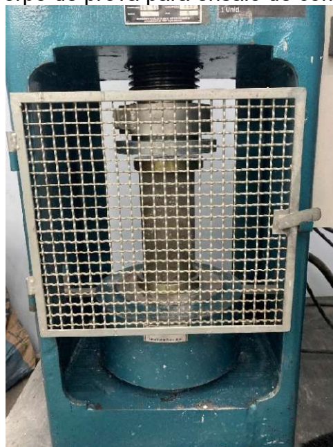
Figura 30 – Corpo de prova para ensaio de compressão axial.
