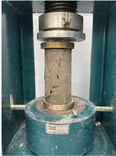
Figura 31 – Corpo de prova após ensaio de compressão axial.
