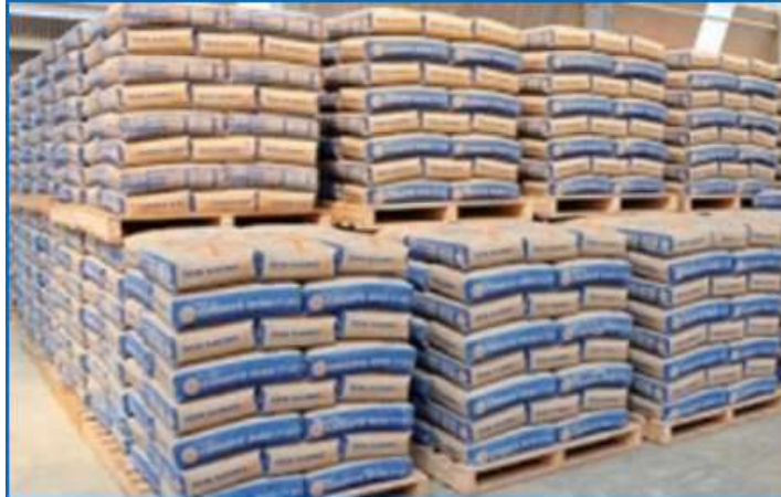
Figura 6 - Exemplo para armazenamento do cimento.
