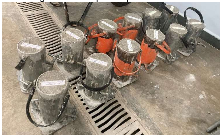
Figura 28 – Corpos de prova no molde.
