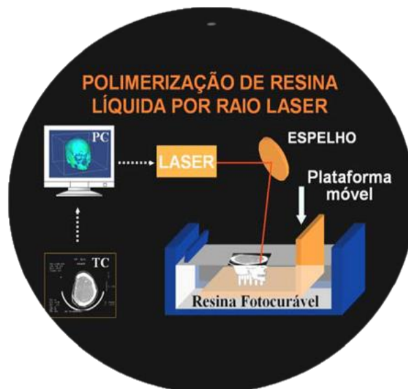
Figura 2 - Diagrama da técnica de estereolitografia.
